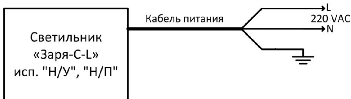
Рисунок 1.11. Схема подключения светильника «Заря-С-L» исп. «Н/У», «Н/П».
